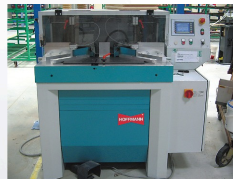
Automatische Fräs- und Bohrmaschine PP-2-NC
